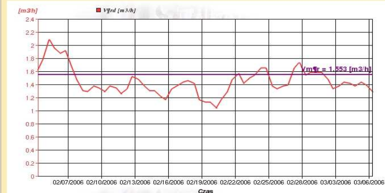
2. Wykres średniodobowego przepływu czynnika grzewczego w funkcji czasu i w odniesieniu do ustalonego max. przepływu
